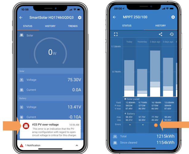
Ein aktiver Fehler und ein historischer Fehler.
